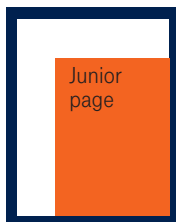
■ Clean size (w x h) 119 x 201 mm ■ Bleed format (w x h) 134 x 220 mm
